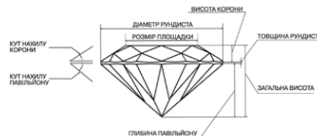
Рис. 3. Основні розміри елементів огранування брильянта
