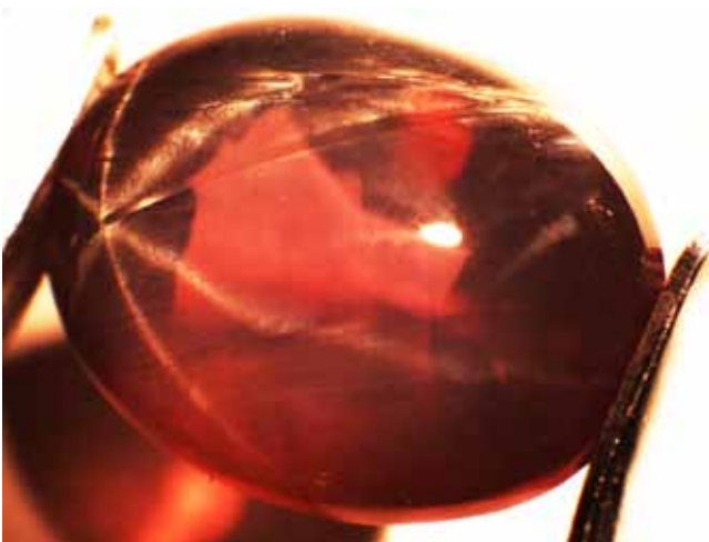
Рисунок 1. Загальний вигляд синтетичного сапфіра з ефектом астеризму, синтезованого методом Вернейля
