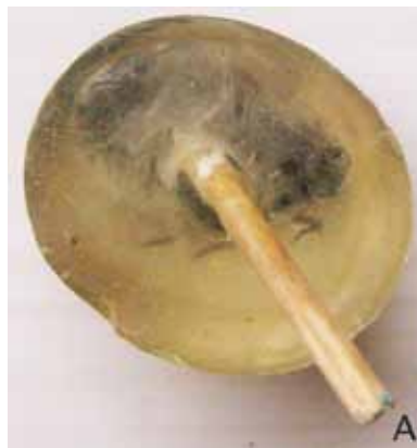
Рисунок 3. Приклад помутнілої (А) і спіненої (Б) епоксидної заливки
