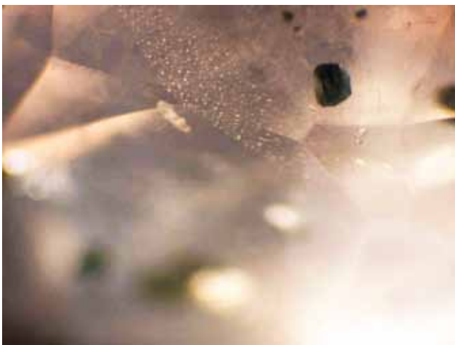
Рисунок 4. Газово-рідні включення в рожевому кварці, мікроскоп «Gemmaster L 230V», зб. 36 (фото Гаєвського Ю.Д.)
