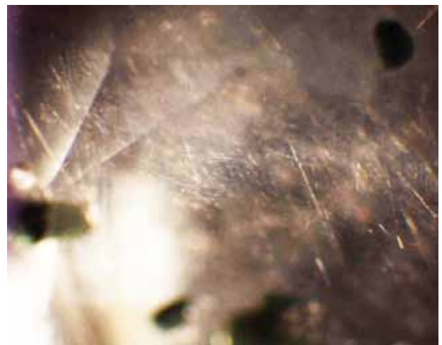
Рисунок 5. Голчасті включення рутилу в рожевому кварці, мікроскоп «Gemmaster L 230V», зб. 36 (фото Гаєвського Ю.Д.)
