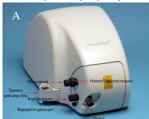
Рисунок 3 Зовнішній вигляд (А) та внутрішня будова робочої частини (Б) приладу DiamondView™
