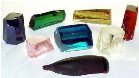
Рисунок 1 – Кристали синтетичного корунду синтезованого за методом Вернейля.
