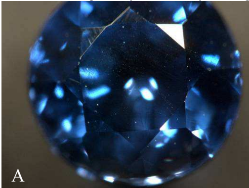
Рисунок 6 – Каблучка з синтетичним сапфіром. Форма огранування круг. Вид з боку корони. Видиме світло (А). УФ-світло (Б). Простежуються вигнуті лінії росту характерні для синтетичного сапфіру та скупчення газових пухирців (Б).
