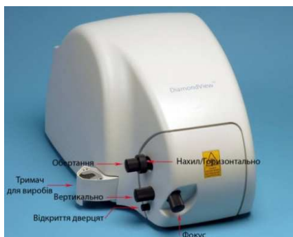
Рисунок 6. Зовнішній вигляд приладу «Diamond View» та його внутрішня будова
