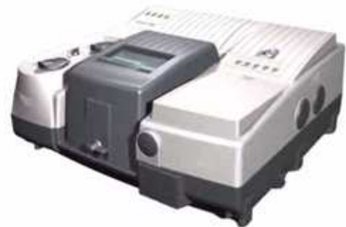
Рисунок 1. ІЧ-спектрометр «Thermo Nicolet 6700 FTIR» з приставкою «Collector II»
