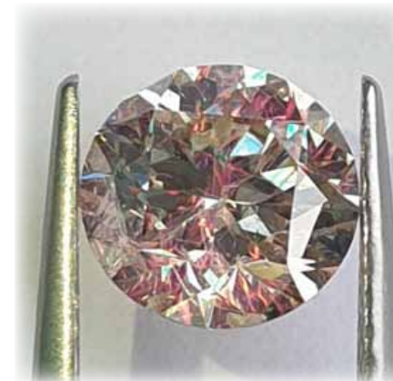
Діамант, облагороджений методом заповнення тріщин
