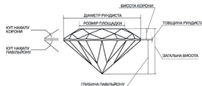
Рис. 3. Основні розміри елементів огранування брильянта
