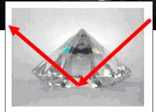
Рисунок 2а. Проходження ІЧ-променя через досліджуваний зразок
