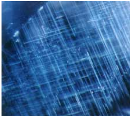
Рисунок 7. Включення рутилу до і після термообробки рубінів
