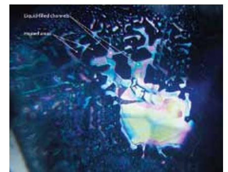
Рисунок 6. Залікована тріщина в сапфірі. Структура заліковування співвідноситься зі структурою кристала, розташування залікованих областей повторює кристалографічну структуру сапфіра (у цьому випадку під кутами 60/120^\circ )
