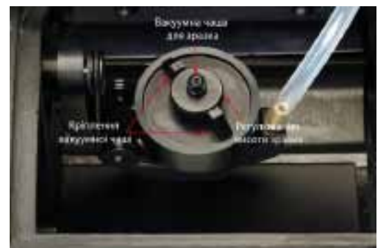
Рисунок 8. Зовнішній вигляд приладу «Diamond View» та його внутрішня будова
