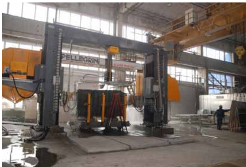
Рисунок 1. Алмазно-канатная распиловочная машина на производстве ООО «АКАМ»
