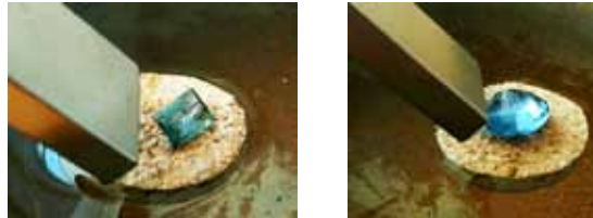
Рисунок 2. Природна шпінель (ліворуч) на плотуку з коркового дерева притягується до магніту, синтетична кобальтова шпінель (праворуч) – відштовхується
