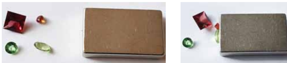
Рисунок 1. Дорогоцінні камені групи гранату до і після магнітного тестування. Демантоїд і спесартин демонструють сильну атракцію, піроп тягнеться за магнітом, цаворит не притягується. Розмір магніту 30×20×4,7 мм, вага 19 г
